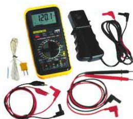
ESI585 Electronic Specialties (USA) Automobilový multifunkční multimetr. Otáčky motoru 0 - 3200RPM, 12000RPM, úhel sepnutí kontaktů pro 3, 4, 5, 6 a 8 válců, předstih 0 - 90°, tester diod, teplota do 750°C, napětí DC do 1000V, napětí AC do 750V, proud DC / AC do 10A, odpor do 32M ohm, frekvence 0 - 320Hz, 3,2kHz, 32kHz. 42 rozsahů s automat. změnou rozsahu, data hold, bzučák, bargraf, proudové kleště a další.
