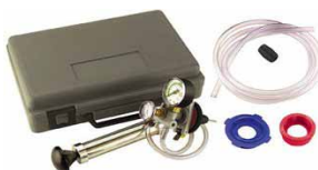
KD3582 KD Tools (USA) Souprava pro test těsnosti chladicí soustavy. Pomocí gumového nafukovacího balónku a redukce lze použít pro převážnou většinu chladicí systémů, natlačit a sledovat tlak na manometru a teplotu na teploměru při chodu motoru.
