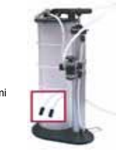
MIT7201 MityVac (USA) Odsávačka oleje a chladicí kapaliny, objem 8,8L • Vytváří tlak i podtlak • Umožňuje odsávat i napouštět většinu automobilových kapalin a náplní • Externí vysokooobjemová ruční pumpa • Kapacita zásobníku 8,8L • Ventil zabraňující přetečení zásobníku • Bezpečnostní přetlakový ventil • Trvanlivá polyetylenová konstrukce • Sada hadic pro odsávání oleje v místě pro měrku
