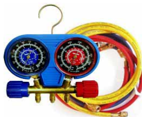
ROB41640 Robinair (USA) Souprava manometrů s ventily a třemi hadicemi 72" LP manometr: -1 až 8 bar po 0,1 bar (0-120 psi), max. 24 bar / 350 psi. HP manometr: 0 až 34 bar po 0,5 bar (0-500 psi). Průměr číselníků 64 mm zaručuje snadné čtení hodnot i z větší vzdálenosti. Manometry jsou vsazeny do měkkého plastového pouzdra s hákem pro zavěšení a chráněny proti nárazu. Na zadní straně je kapsa pro teplotní tabulku (°F) pro 10 typů chladiv (R134a, R12, R22, ...). Hadice Enviro-Guard™ (3ks) - délka 1830 mm. Koncovky hadic: 1/4" FFL Quick Seal Fitting. Maximální pracovní tlak hadic - 51 bar / 740 psi, tlak roztrhnutí - 255 bar / 3700 psi.
