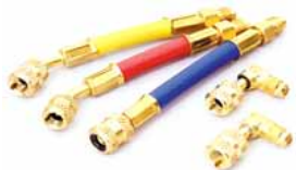
ROB10237A Robinair (USA) Sada 3 spojovacích hadic a 2 adaptérů Modrá hadice 1/4" F x 1/8" M Červená hadice 1/4" F x 3/16" M Žlutá hadice 1/4" F x 1/4" M Adaptéry 3/16" F x 1/4" M a 1/4" F x 1/4"
