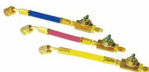
ROB18514 Robinair (USA) Sada 3 adaptérů 1/4" M x 1/4" F s kulovými ventily Po zařazení do okruhu s plnicími hadicemi umožňují kontrolu a regulaci průtoku chladiva. Fitinky jsou pod 45° pro snadnější montáž v obtížně přístupných místech. Délka adaptérů je 152 mm.
