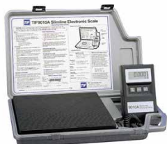
TIF9010A TIF (USA) Přenosná elektronická váha 50kg (110lb) s rozlišením 2 gramy. Přesnost 0,5% zobrazené hodnoty Automatické nulování. Volitelné rozsahy: 0.000kg do 50.000kg, 0lb 0.0oz do 110lb. 0.0oz., 0.000lb. do 110lb. Oddělený ovládací panel s displejem. Možnost vyjmutí váhy z plastového kufríčku. Napájení z baterie 9V.
