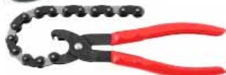
KD2031 KD Tools (USA) Řezač výfukových trubek Pro průměry 19 - 76 mm. Celkem 15 ostří přeřízne trubku po 90° pootočení.
