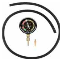
KD2521 KD Tools (USA) Tlakoměr a vakuoměr palivového čerpadla. Pro test tlaku v palivovém potrubí, test tlaku a podtlaku palivového čerpadla, test těsnosti a ztráty tlaku nebo podtlaku, test netěsných ventilů, seřízení tlaků zapalování a další. Manometr 0 - 28" Hg (700mm Hg) a 0 - 15psi
